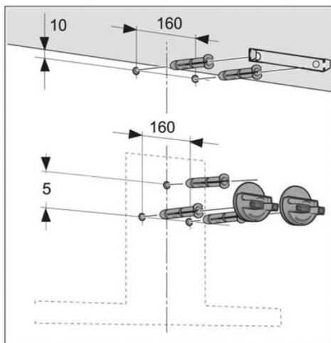
4. Закрепите планку для крепления внутренней части кожуха вытяжки к стене (рис. 9).
