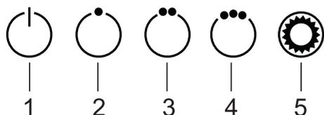
На лицевой панели вытяжки LEVANA PB посередине расположен кнопочный переключатель режимов работы мотора и ламп освещения (рис. 4).
