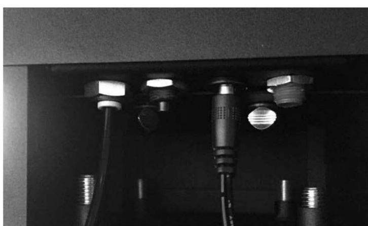
После того, как прибор закреплен на стойке, подключите черный шланг подачи CO2 в серое стыковое соединение и источник питания в гнездо, как показано на рисунке.
