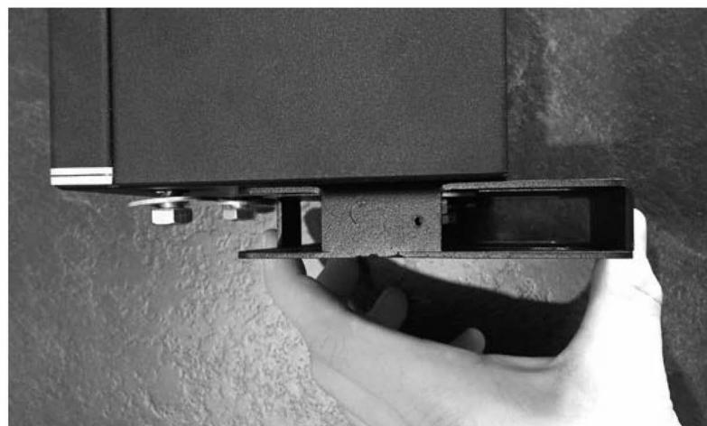
Ослабьте 4 винта, которые крепят основание прибора к крепежной планке.
